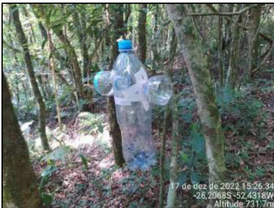
Figura 56 - Armadilha com iscas de cheiro instalada para coleta da entomofauna.
