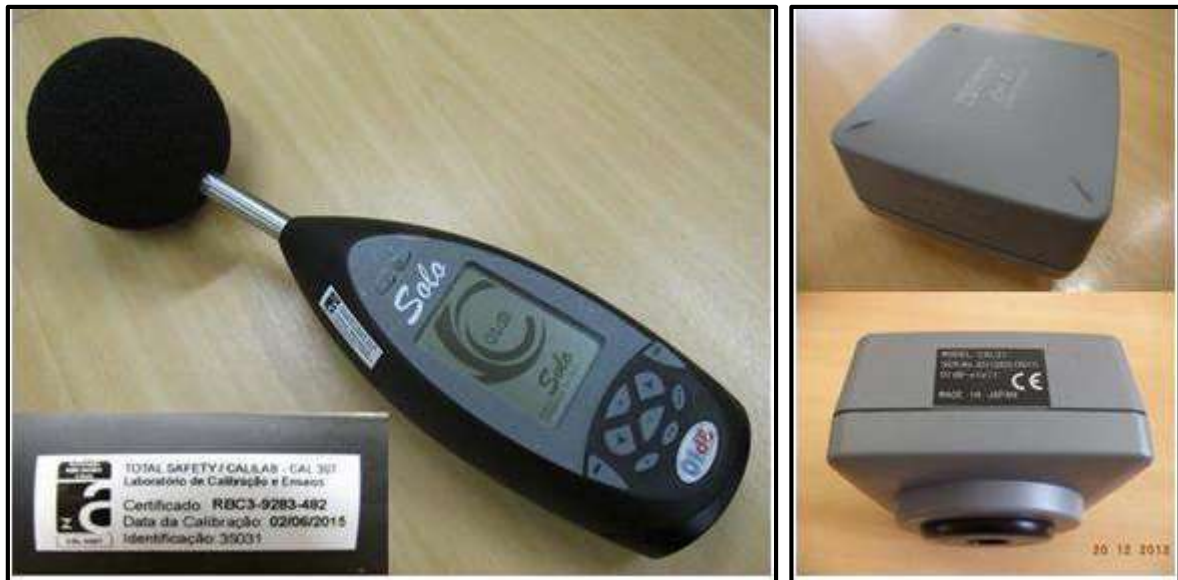
Figura 31 - Exemplo do medidor integrador de nível sonoro (MINS) e calibrador acústico utilizados.
