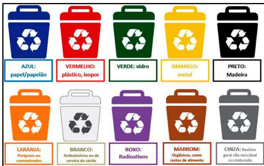
Figura 28 - Código de cores para segregação de resíduos, conforme Resolução Conama nº 275/2001.
