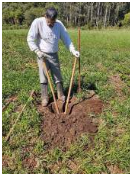
Figura 51: Visualização do procedimento de escavação da sondagem 01. Coordenada UTM (22J) 360224 - 7093039.
