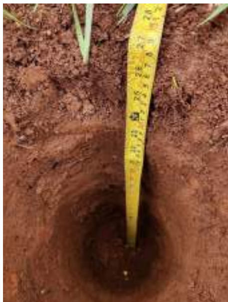
Figura 115: Sondagem 33 finalizada e com bloco de basalto na base impedindo a continuidade da escavação. Coordenada UTM (22J) 360244 - 7092979.
