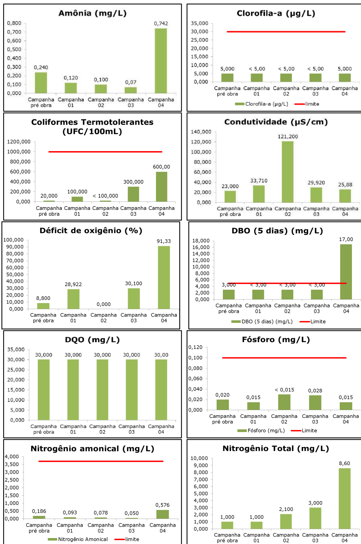
Figura 81 - Resumo gráfico dos resultados para o ponto P03 - Vazão reduzida.
