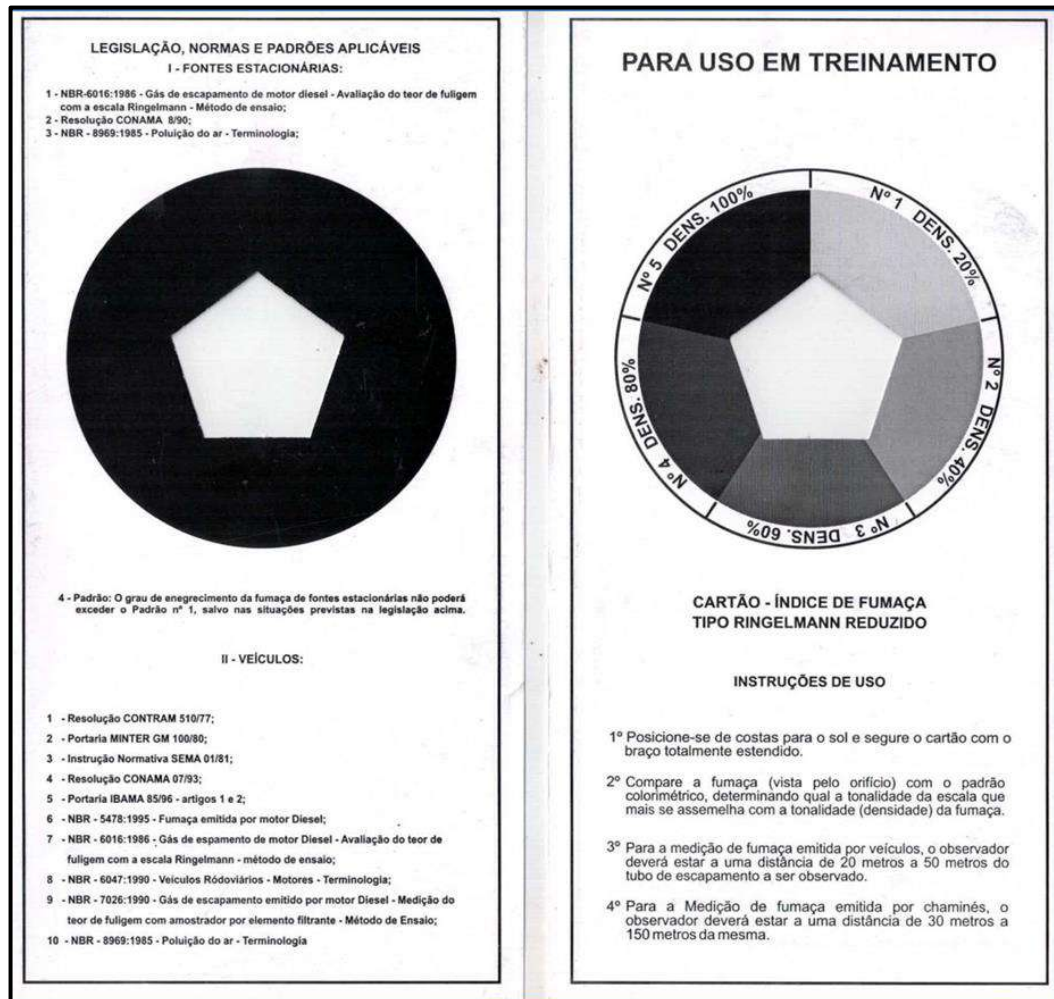
Figura 17 - Escala de Ringelmann.
