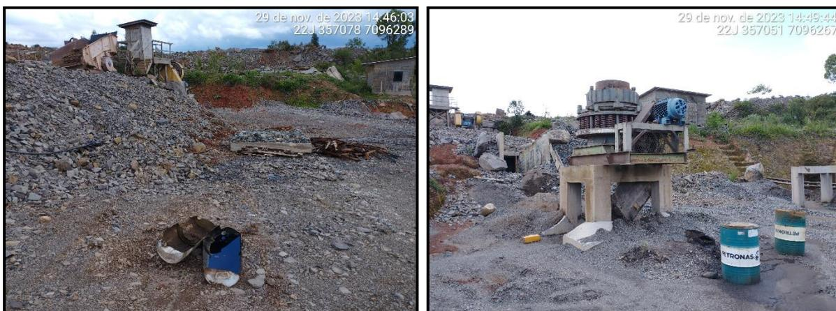
**Figura 193 - Bandeja de óleo e tambores expostos em local inadequado.**
